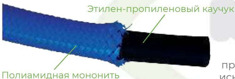
Внутренний шланг изготовлен из нетоксичной резины EPDM. Наружная оплетка из фибронейлона позволяет избежать заломов, прокалывания внутреннего шланга, предотвращает образование конденсата, исключает передачу на корпус смесителя блуждающих токов, вызывающих окисление металла.
